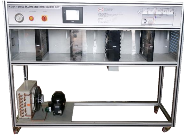
Şekil 1. Temel iklimlendirme eğitim seti deney düzeneği
