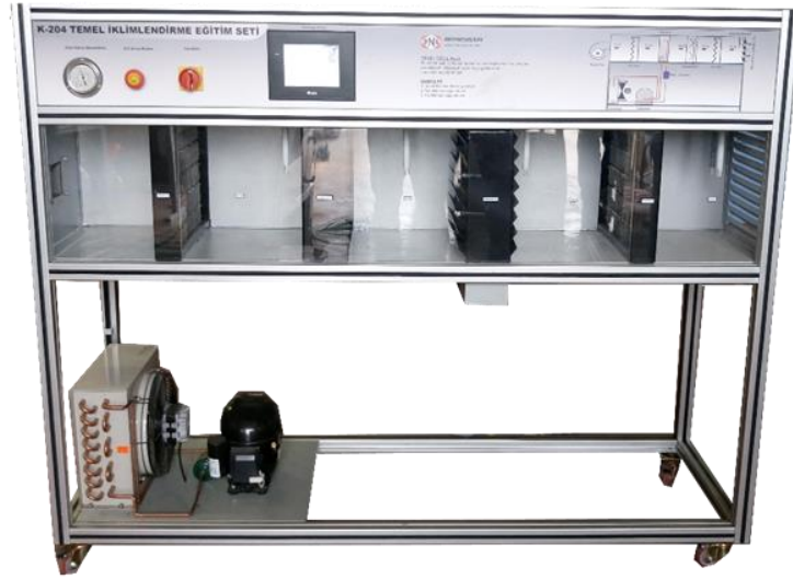
Şekil 1. Temel iklimlendirme eğitim seti deney düzeneği
