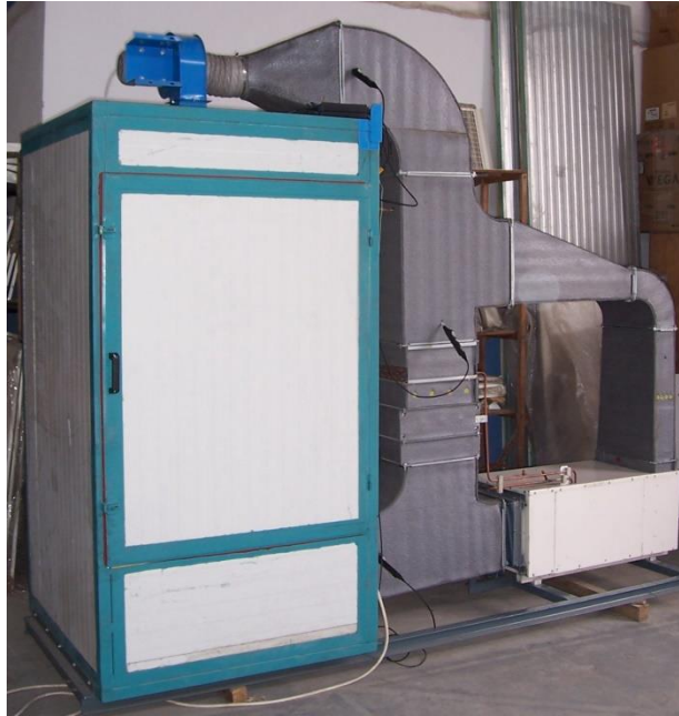
Şekil 2. Isı pompalı kurutucunun deney düzenegi
