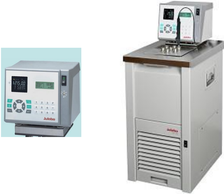
Şekil 1. Kalibrasyon banyosu JULABO FK30-SL
