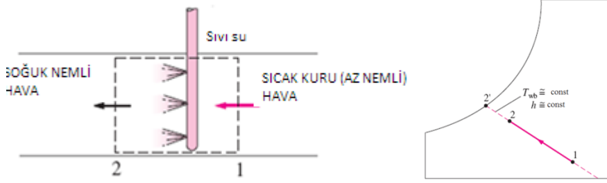
Şekil 4.6.1 Evaporatif soğutma prosesi
