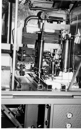
Şekil 6 Doğal gazla çalışan, 2 KW gücünde katı oksitli yakıt pili sisteminin bir görüntü, Ceramic Fuel Cells Limited Avustralya
