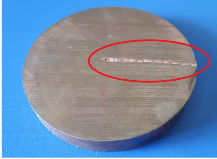
Şekil 5.11. Termokupl telinin geçebilmesi için ısıtma ve soğutma bölümüne açılmış olan ince kanal.
