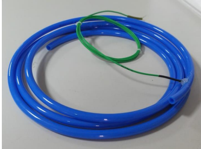
Şekil 5.10. Termokupl probu yerleştirilmiş olan boru.
