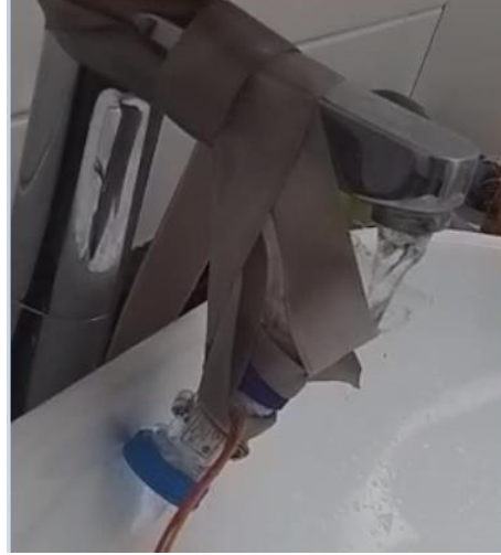
Şekil 5.13. Musluk suyundan beslenen akış sensörü düzeneği.
