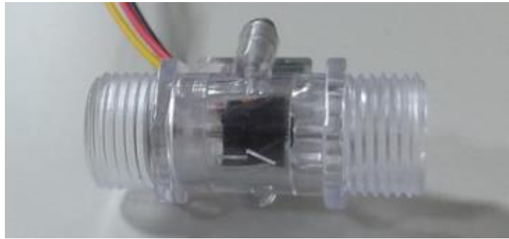
Şekil 5.12. Debi ölçümü için kullanılan su akış sensörü.
