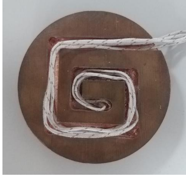
Şekil 5.9. Rezistansın bakır kanalından geçirilmiş hali.
