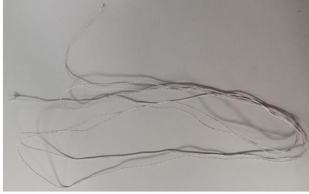
Şekil 5.7. Rezistans olarak kullanılan T tipi termokupl.
