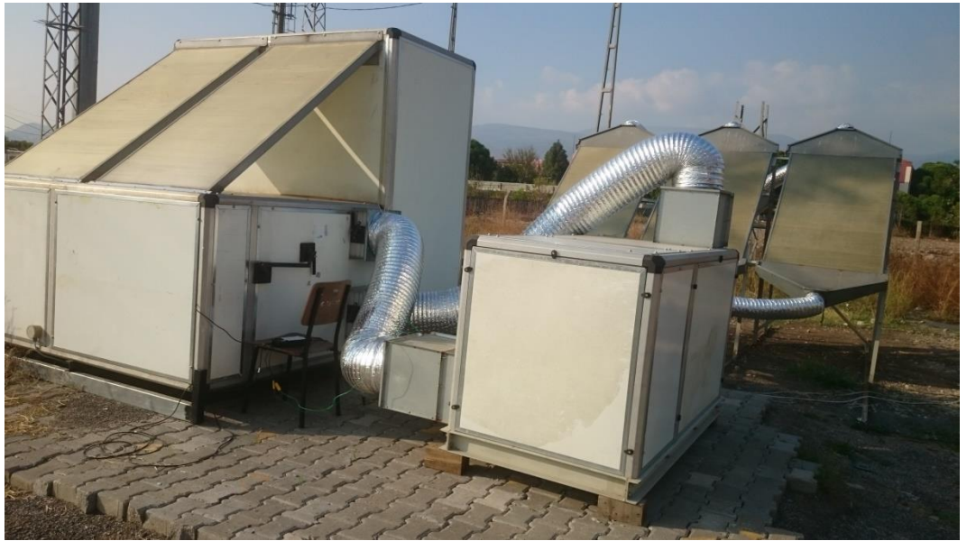
Şekil 4.2. Güneş enerjisi destekli ısı depolama sistemli ürün kurutma sistemi resmi.
