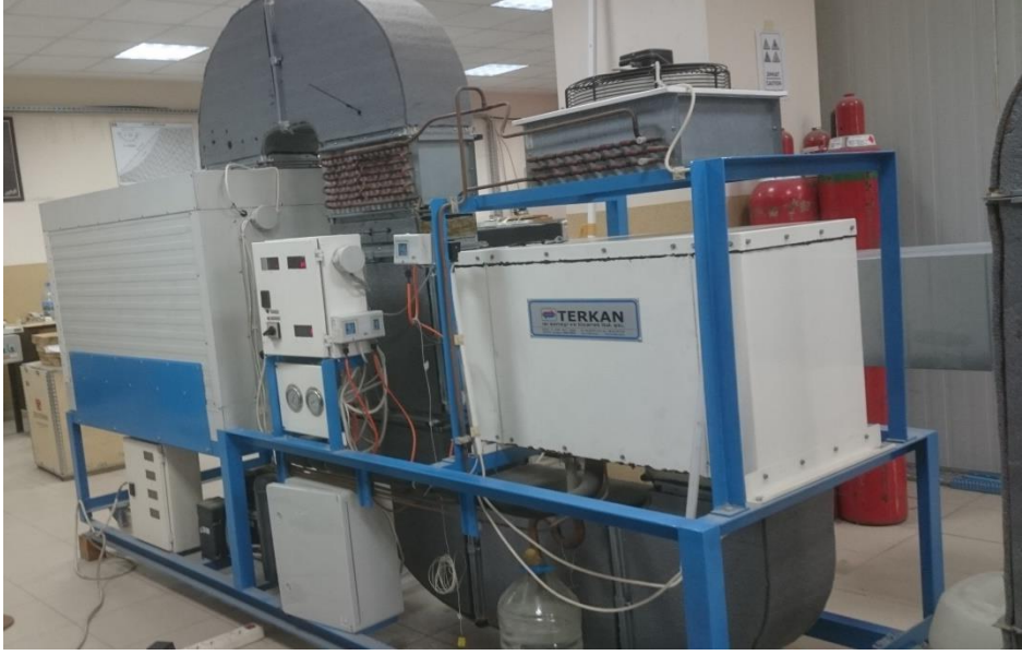
Şekil 5.9. Isı pompalı kurutucunun deney düzeneği.
