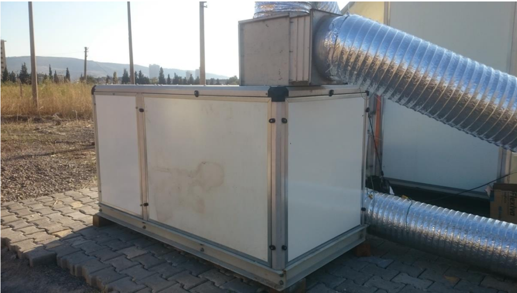
Şekil 4.16. Parafin ısı enerji depolama sistemi kapalı hali.
