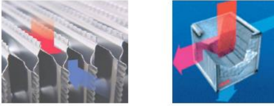
Şekil 4.7. Plakalar arası sıcak ve soğuk hava akış yönleri.
