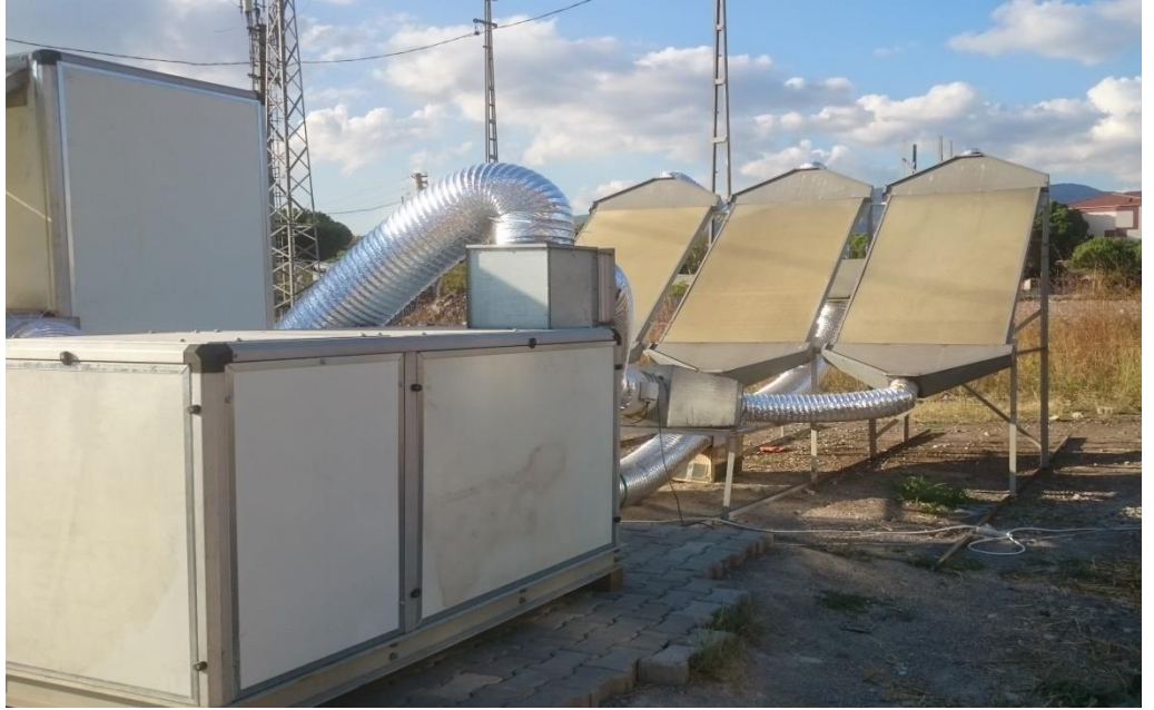
Şekil 4.18. Parafin ısııl enerji depolama sistemi resmi.
