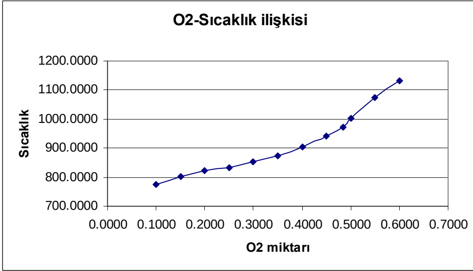
Şekil 4.5 Oksijen miktarındaki değişimin yakıt dönüştürücü çıkışındaki sıcaklığa etkisi.
