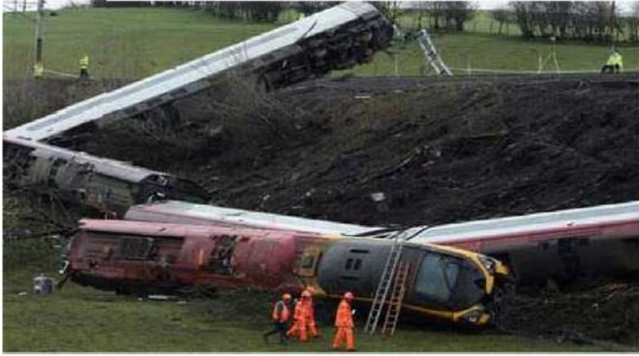
Şekil 3.1 Derayman (de Aguiar et al., 2018)
