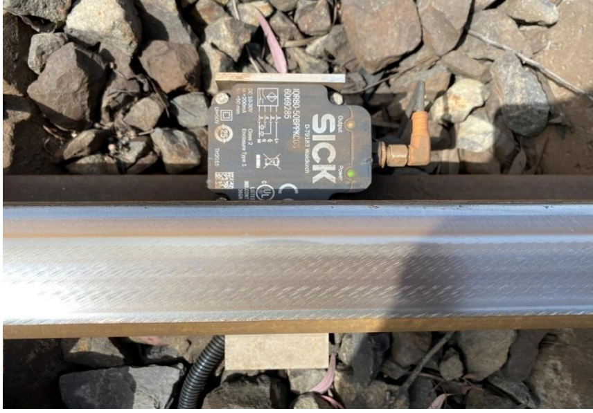
Şekil 4.1 Hat üzerinde endüktif sensör yerleşimi
