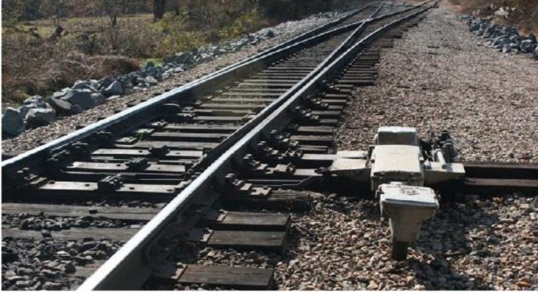
Şekil 3.2 Demiryolu makası(de Aguiar et al., 2018)
