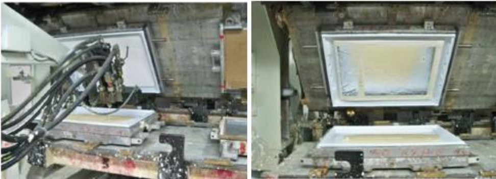
Şekil 6.11 Kapılar için kullanılan PU basma sistemleri (Müminoğlu, 2015)
