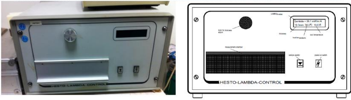
Şekil 6.3 Çalışmada kullanılan ısı iletim katsayısı ölçüm cihazı (Müminoğlu, 2016)
