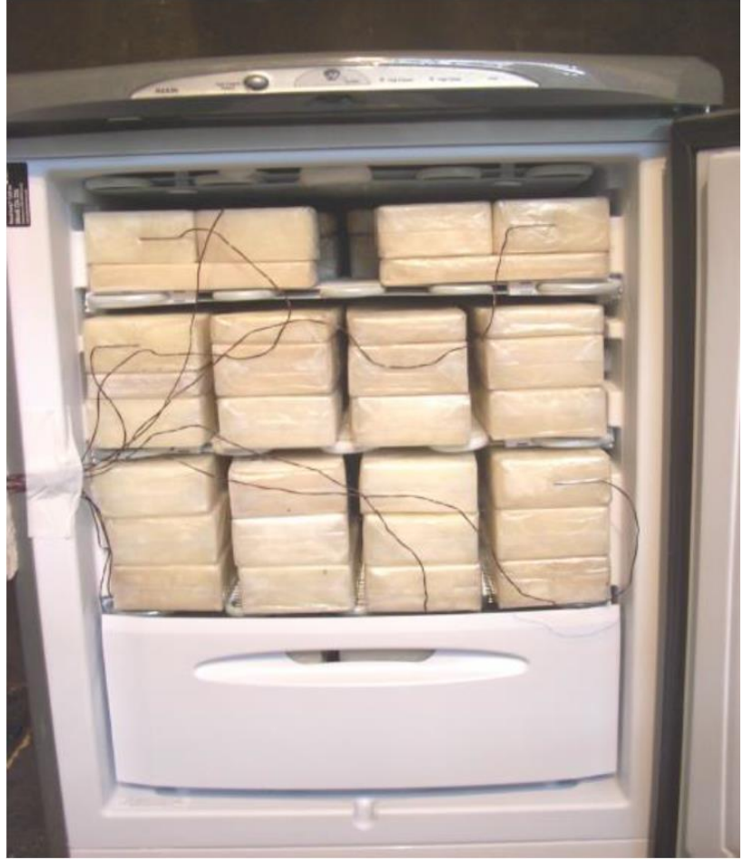
Şekil 7.3 Enerji ve performans testlerine hazırlanmış ürün (Müminoğlu, 2016)
