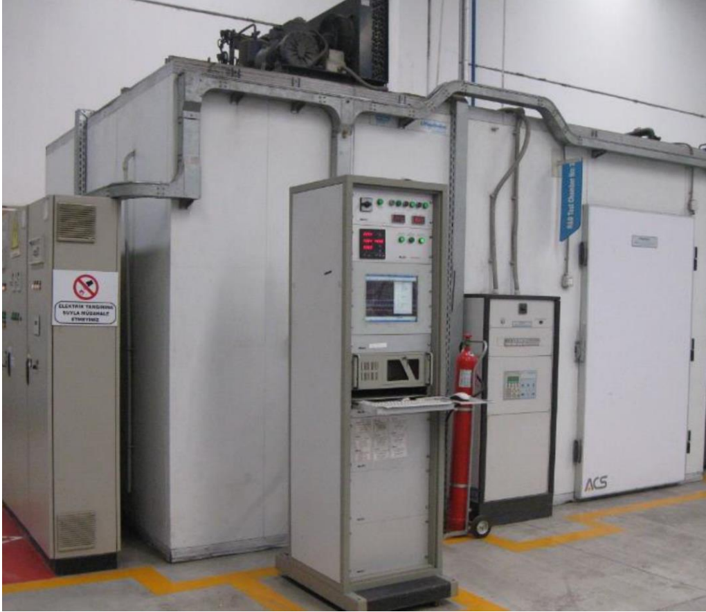
Şekil 6.15 İklimlendirilmiş test odası (Müminoğlu, 2015)
