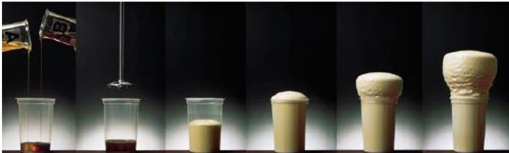
Şekil 6.8 PU kürlenme aşamaları (BASF)
