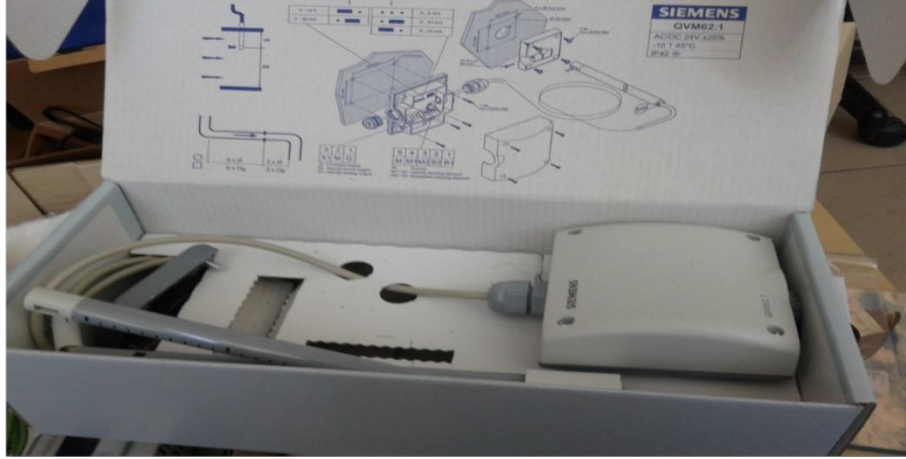
Şekil 4.34 Anemometre(hava hızı ölçüm cihazı) resmi
