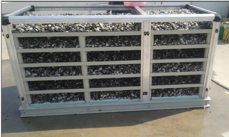
Şekil 4.17 Çakıl taşı enerji depolama sistemi açık hali
