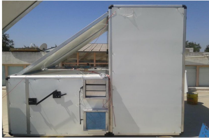
Şekil 4.6b Kurutma kabini montaj resmi (son hali)
