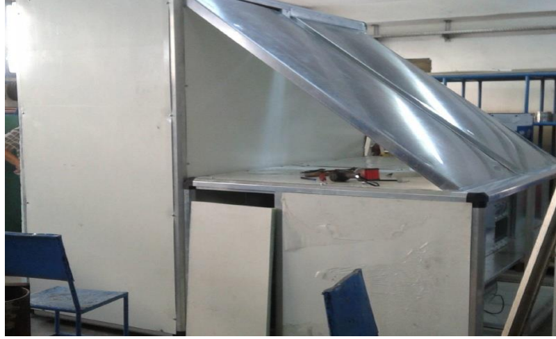
Şekil 4.6a Kurutma kabini montaj resmi (yapım aşaması)
