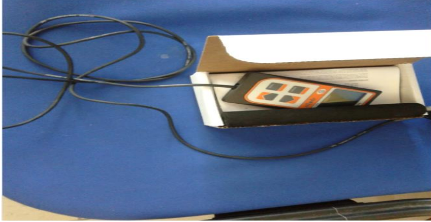
Şekil 4.37 Piranometre (güneş ışınlamı ölçümü cihazı) resmi
