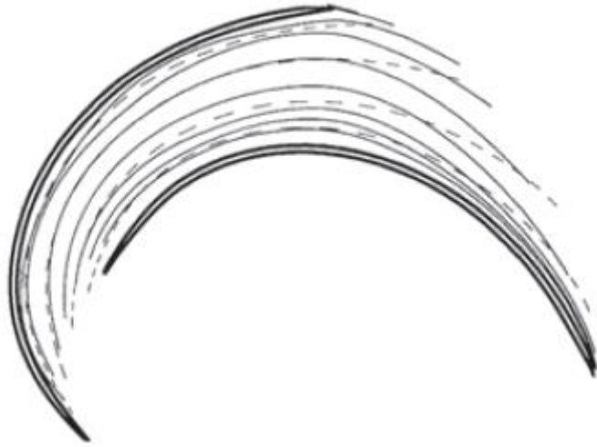
Şekil 2.9. Çark içindeki bağıl akış; noktali çizgiler kanat uyumlu akışı göstermekte. (Gulich, 2010)
